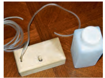
その後、患者さんが直接栽培にかかわれるよう、足の指でスイッチを押す水やりができる器具も開発しました
